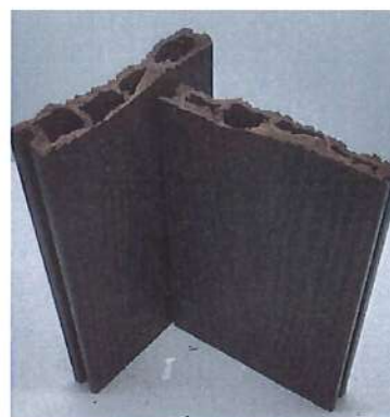
Рисунок 3 – Испытанный образец после определения изгибающего напряжения, относительной деформации при изгибе и модуля упругости при изгибе
